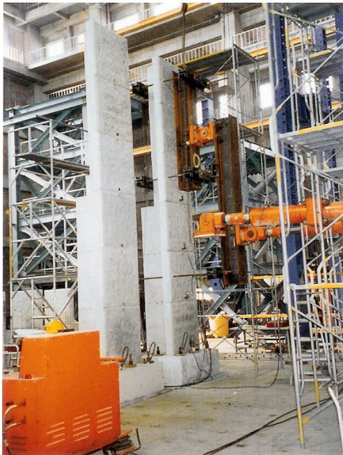
建設省建築研究所における構造耐力試験
